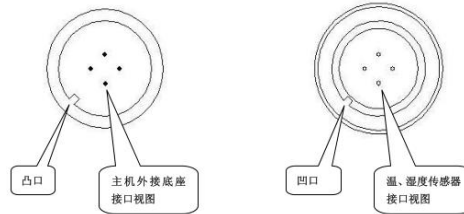
图 17 温、湿度传感器安装图 1
